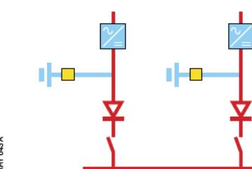
Схема расширенного полного резервирования
